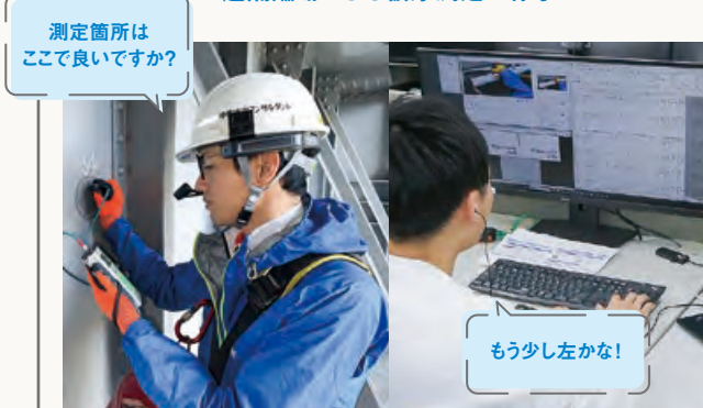
遠隔臨場による板厚測定の様子
