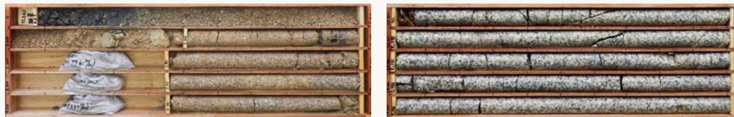
本技術で採取したボーリングコア（左：礫混じり土砂、右：岩盤）
