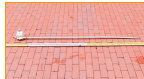
測定棒(2m): 熱電対3対とヒーター線を内蔵
