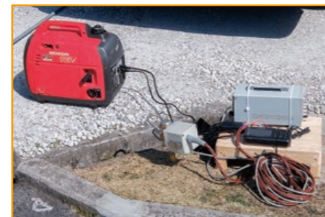
測定状況: 測定棒内のヒーター線を加熱し、 上昇温度測定を行う
