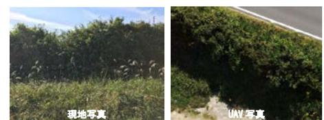
堤防の植生高は、UAV写真測量から得られた標高データと法面標高（裸地部の法肩と法尻を結ぶ直線高さ）との差分により算出
