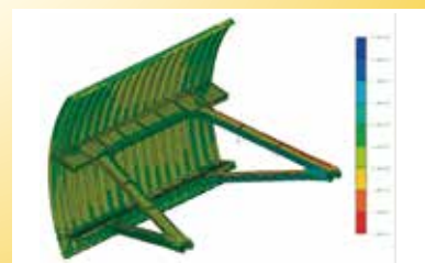
鋼構造物健全度解析 (FEM解析)
