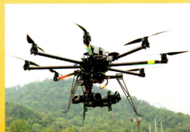
UAVによる画像点検
