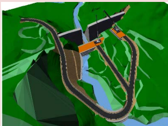
砂防堰堤のCIM統合モデル
