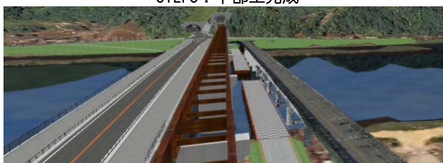
STEP4：上部工（主桁）完成
