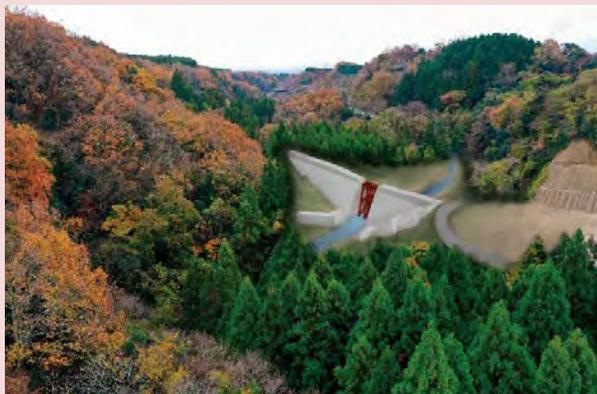
砂防堰堤の鳥瞰図(斜め写真と3次元モデルを合成)
