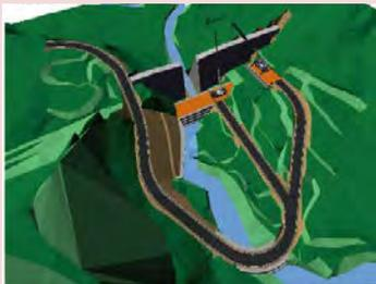
砂防堰堤のCIM統合モデル
