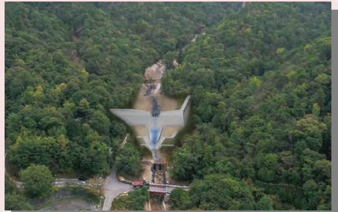
砂防堰堤の鳥瞰図（斜め写真と 3次元モデルを合成）
