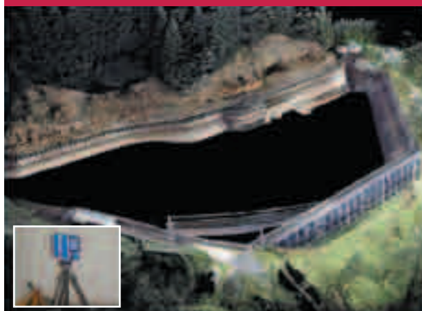
発電所の調整池の3次元モデル
