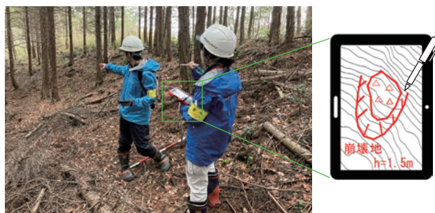
地表地質踏査へのDX技術活用（タブレット端末による現地作業の効率化）
