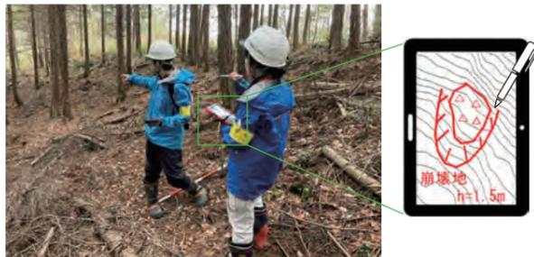
地表地質踏査へのDX技術活用(タブレット端末による現地作業の効率化)
