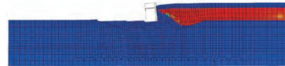
岸壁における変形図・過剰間隙水圧分布図（赤いほど液状化）
