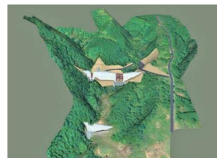
土砂災害防止のための砂防施設設計におけるCIMモデルの活用事例
