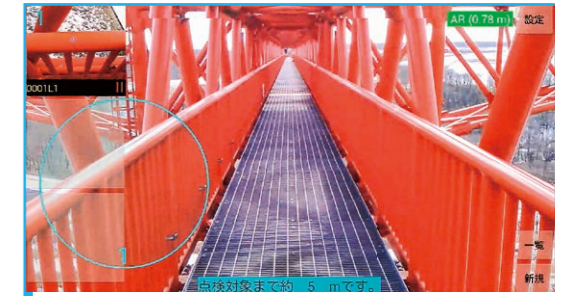
ARによる損傷特定イメージ
