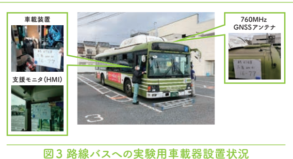
図3 路線バスへの実験用車載器設置状況
