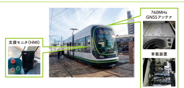
図2 路面電車への実験用車載器設置状況
