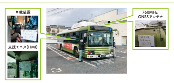
図3 路線バスへの実験用車載器設置状況
