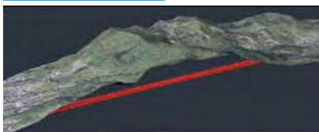
地形及びトンネル設計データの3次元化
