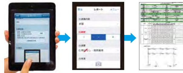
野帳の整理が間に合わない → 現地で道路附属物点検調書を作成
