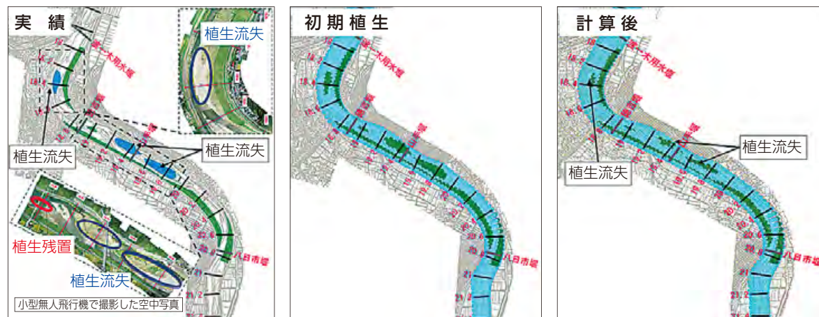
植生の遷移予測を組み入れた平面二次元河床変動シミュレーション結果の例
