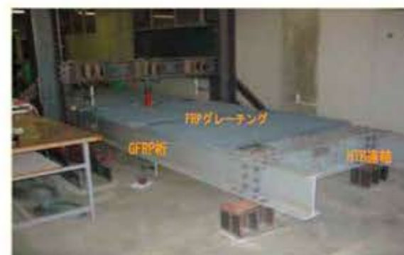
図8. FRP函々渡橋実物大実験(広島工業大学)
