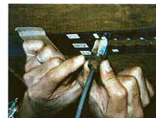
磁気プローブによる測定状況
